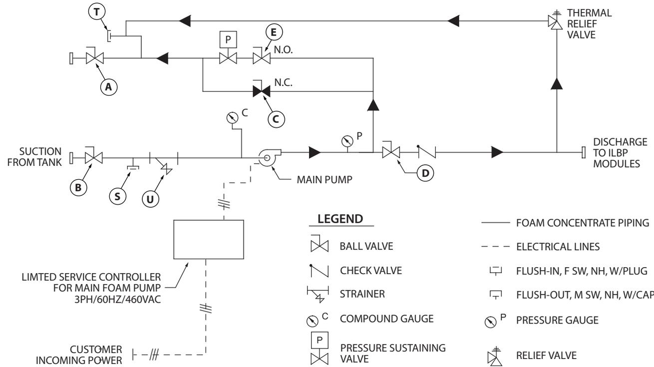
**P & ID FOR IN-LINE BALANCED PRESSURE PROPORTIONING SKID PAK**
